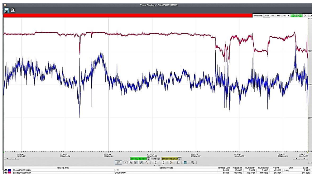
Slika 13: Promena toplotne moći uglja (plavo) i aktivna snage (crveno) na generatoru tokom perioda probnog pogona
